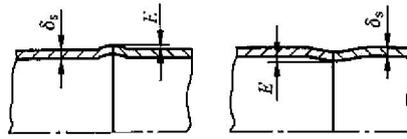
图6 焊接接头处的轴向棱角
