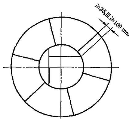
图 1 分瓣成形凸形封头的焊缝布置
