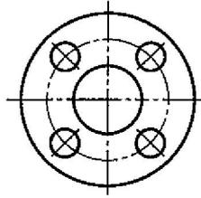
图 8 法兰螺栓孔的跨中布置
