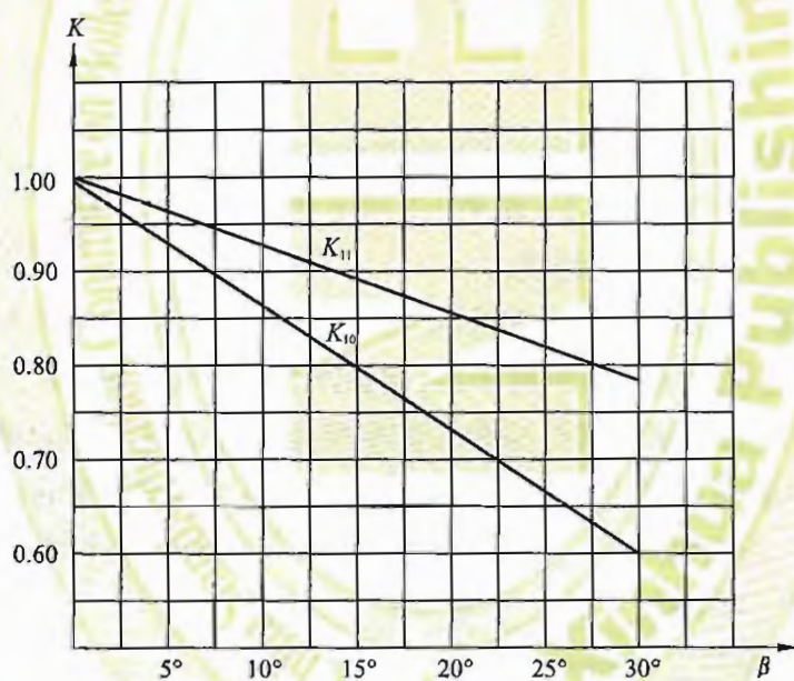
b) 系数 K_{10} 、 K_{11} 与夹角 \beta 的关系曲线图
